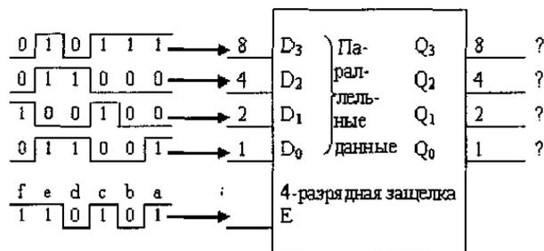
3. Перечислить десятичные выходные сигналы (показания индикатора) для каждого входного импульса. Перевести полученные результаты в восьмеричную систему счисления. Перевести десятичные числа: 18; 73; 965 в код ДДК.
